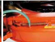
Anschluß für Wasserschlauch zur Mähwerksreinigung.
